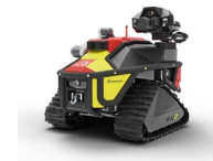
【無人走行放水ロボット】
